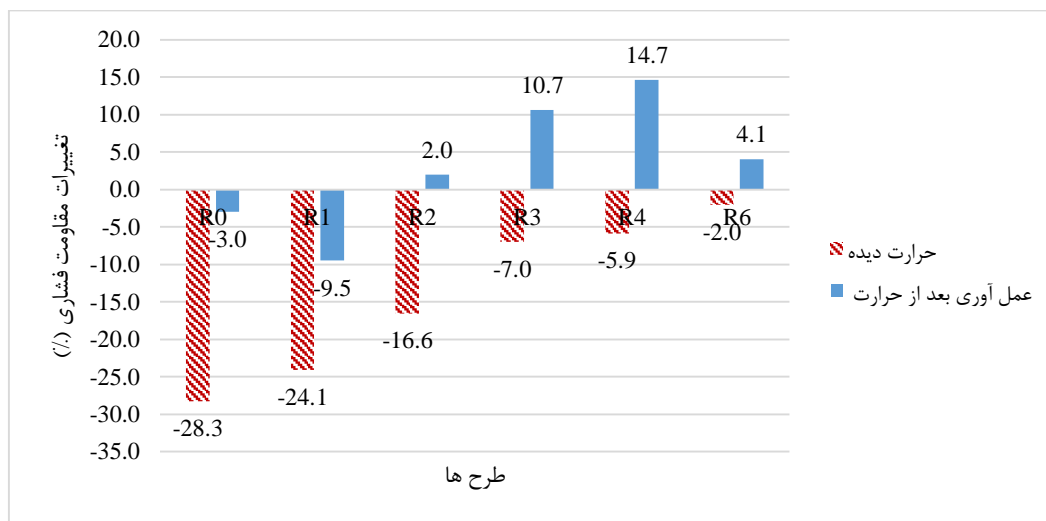
شکل ۱۱: تغییرات مقاومت فشاری نمونه ها در اثر حرارت و عمل آوری پس از آن نسبت به شرایط استاندارد
