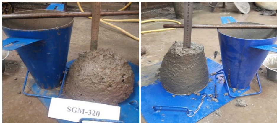
شکل ۳- نحوه انجام آزمایش اسلامپ بر روی مخلوط بتن
