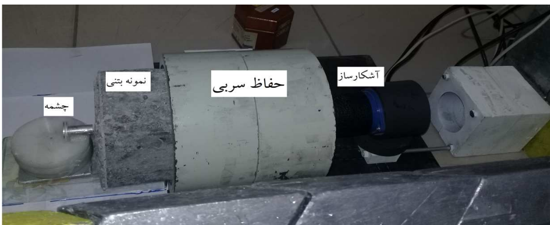
شکل ۱- تصویر آزمایش پرتودهی به بتن توسط چشمه گاما و شمارش توسط آشکارساز NaI(Tl)
