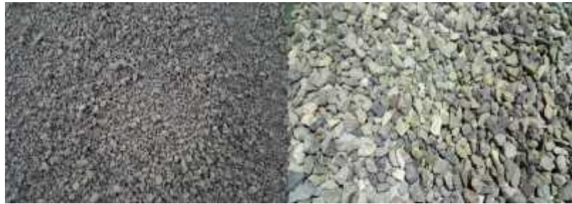
شکل ۱- تصویر مربوط به سنگدانه‌های مصرفی (شن و ماسه) با حداکثر اندازه ۱۹ میلیمتر
