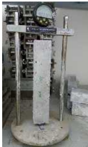
شکل ۴- قرائت طول توسط دستگاه جمع‌شدگی
