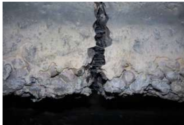
شکل ۸- تصویری از نمونه منشوری بتن سبک خودتراکم حاوی الیاف پس از شکست.
