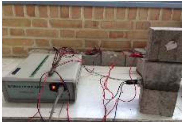
شکل ۲ چگونگی برقراری مدار اندازه‌گیری مقاومت الکتریکی
